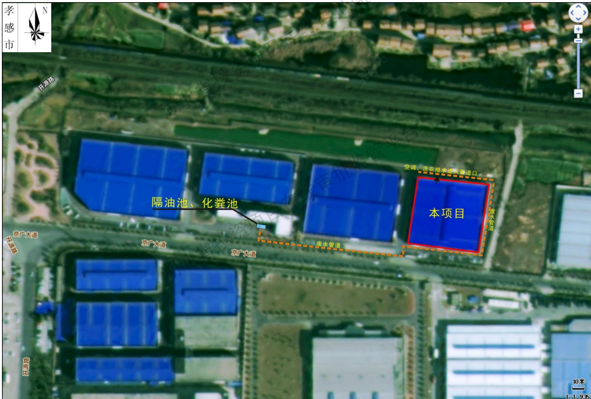
附图 6 项目污水走向示意图
